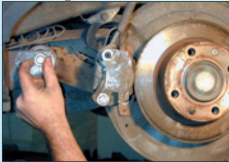
**1** Avant le remontage, ne pas oublier de graisser les tiges des vis. Présenter le bras et mettre en place l'axe.
