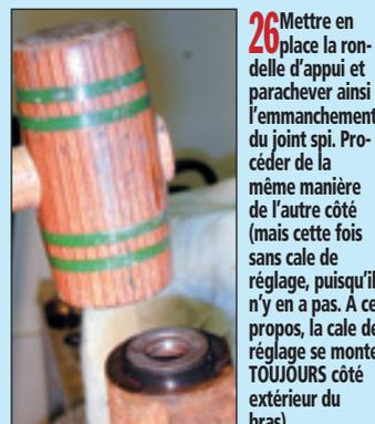
**26** Mettre en place la rondelle d'appui et parachever ainsi l'emmanchement du joint spi. Procéder de la même manière de l'autre côté (mais cette fois sans cale de réglage, puisqu'il n'y en a pas. A ce propos, la cale de réglage se monte TOUJOURS côté extérieur du bras).
