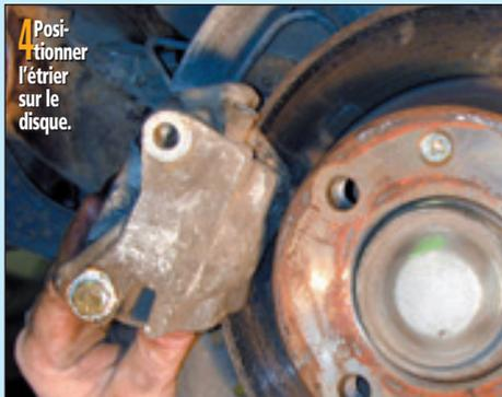
**4** Positionner l'étrier sur le disque.
