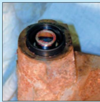
**25** Mettre en place le joint spi et se servir de l'ancien pour l'emmancher.
