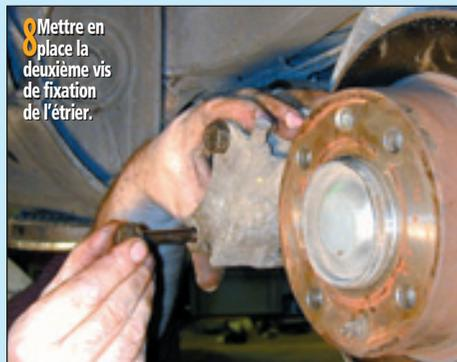
**8** Mettre en place la deuxième vis de fixation de l'étrier.
