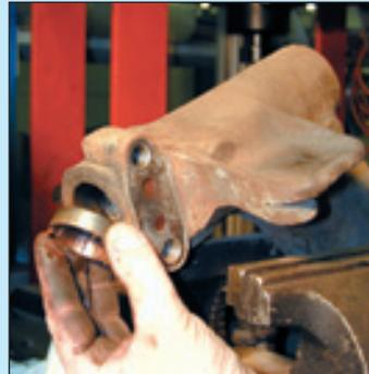
**10** Déposer la cage de roulement. Procéder de la même manière pour la deuxième cage.
