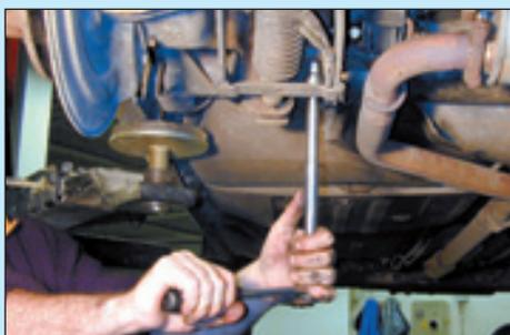
**10** Bloquer les vis de fixation de la bride de barre antiroulis. Il y a, normalement, un couple de serrage (6,5 daN.m) mais, comme dit Gillou, « c'est serré, quand c'est... serré ! ».
