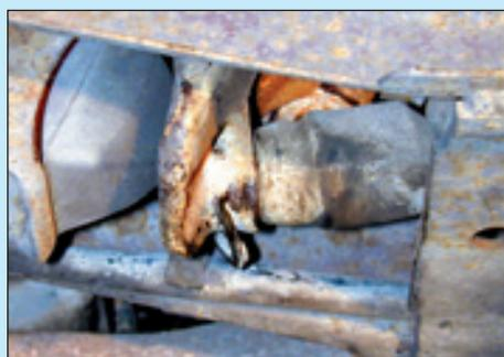
**14** Remettre en place la goupille de tige du cylindre de suspension.
