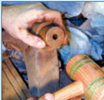
**16** Achever l'emmanchement avec un jet en bronze, au diamètre du logement du roulement.
