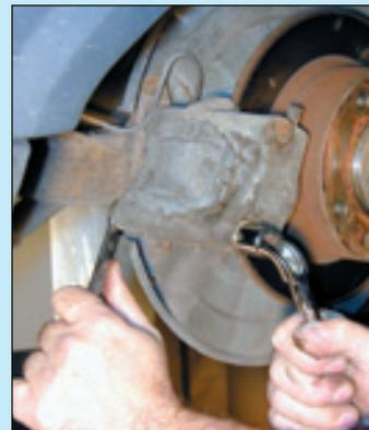
**3** Déposer la vis de fixation inférieure de l'étrier de frein.
