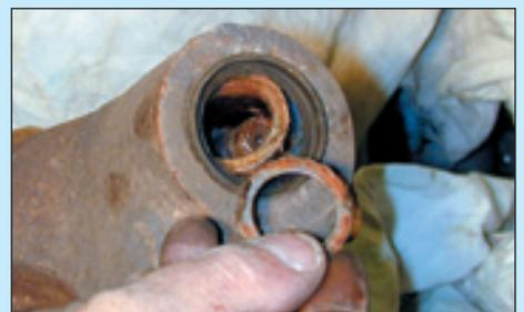
**3** Déposer la cale de réglage et la conserver précieusement. Par principe, on va la remonter pour éviter de se coltiner le réglage de la précharge des roulements. Ça suffit généralement à ne pas avoir de jeu.
