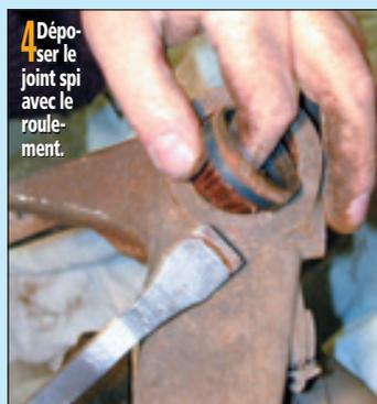
**4** Déposer le joint spi avec le roulement.
