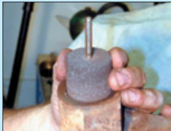
**13** Lorsque les roulements ont battu (en fait, ce sont les galets qui se sont faits la malle), il est préférable de refaire soigneusement le logement en utilisant une petite meule au diamètre du logement du roulement, montée en bout de perceuse ou en utilisant un grattoir et de la toile émeri.
