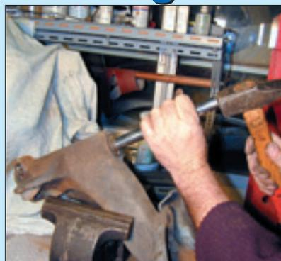
**1** C'est dans l'état qu'on poursuit le travail. Déposer la rondelle d'appui. Il faut ensuite extraire l'axe en acier (sur lequel sont montés les roulements) à l'aide d'un chasse. Celui de Gillou reprend une tige d'amortisseur (ø 22 mm) dont la partie filetée a en partie été conservée pour assurer un parfait centrage et une frappe uniquement sur l'axe.
