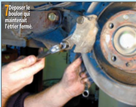
**7** Déposer le boulon qui maintenait l'étrier fermé.
