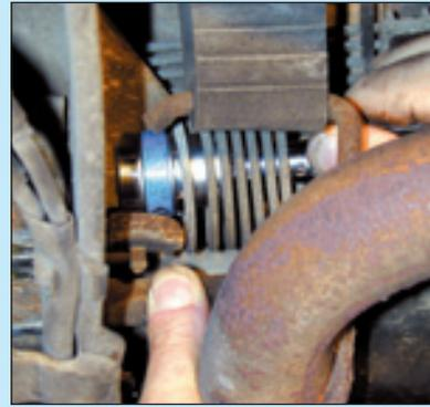
**9** Attention, il faut maintenant déposer l'écrou de maintien de l'axe de bras de suspension. Introduire délicatement la douille de 24 en prenant garde de ne pas "blesser" le tube d'alimentation de frein qui, à cet endroit, fait un très joli serpentín (c'est lui qui assure "l'élasticité" du système, remplaçant avantageusement un flexible en caoutchouc).
