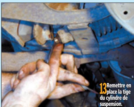
**13** Remettre en place la tige du cylindre de suspension.
