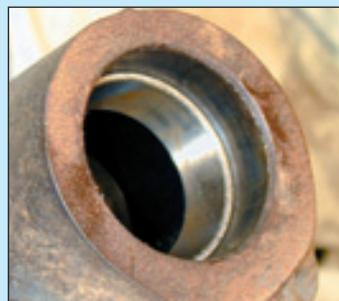
**21** La cage doit être en appui sur sa portée. Le son rendu par le marteau frappant sur le jet ou sur l'ancienne cage résonne alors différemment.
