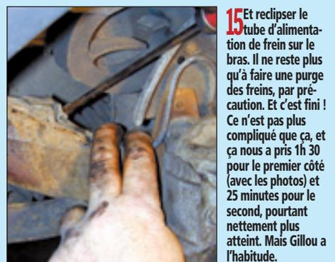
**15** Et reclipser le tube d'alimentation de frein sur le bras. Il ne reste plus qu'à faire une purge des freins, par précaution. Et c'est fini ! Ce n'est pas plus compliqué que ça, et ça nous a pris 1h 30 pour le premier côté (avec les photos) et 25 minutes pour le second, pourtant nettement plus atteint. Mais Gillou a l'habitude.
