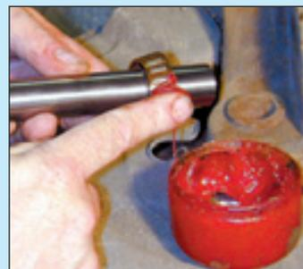
**22** Mettre en place le premier roulement sur l'axe neuf et le graisser généreusement, côté galets, mais également sur les faces supérieures et inférieures.
