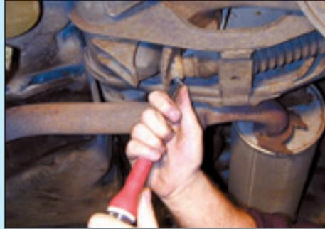
**5** Déposer la goupille de la tige de suspension qui relie le cylindre au bras.
