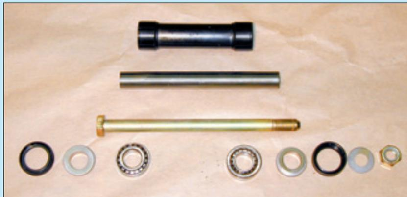
Un kit de réfection est composé d'une cage en plastique, d'un axe sur lequel sont emmanchés les roulements, d'un axe avec son écrou et sa rondelle, de deux joints spi, de deux rondelles d'appui et de deux roulements type Timken (cage et roulement séparés).
