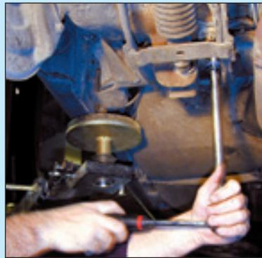
**7** Déposer les deux vis de fixation de la bride de barre antiroulis.
