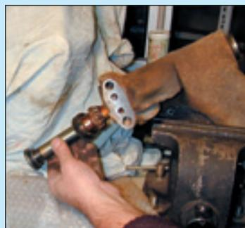
**2** Pan ! L'axe des roulements sort avec la rondelle d'appui, le joint spi et un premier roulement.
