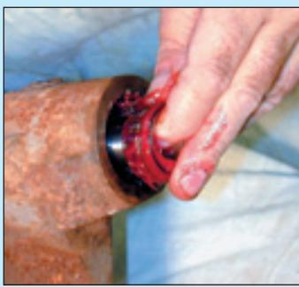
**23** Introduire l'axe avec son roulement, puis mettre en place le second roulement, côté opposé.
