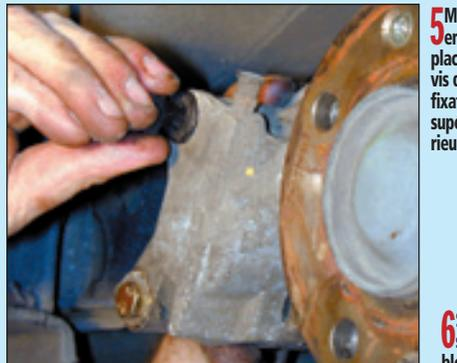
**5** Mettre en place la vis de fixation supérieure.
