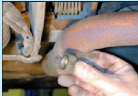
**10** Déposer l'écrou de maintien de l'axe de bras de suspension avec sa rondelle d'appui.
